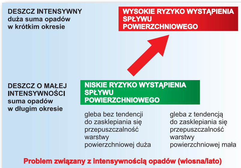
Schemat 1. Związek między przesiąkaniem wody w glebie a ryzykiem wystąpienia spływu powierzchniowego
