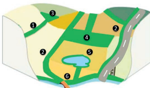
Schemat 6. Położenie stref buforowych w zlewni; 1 – strefa buforowa w obrębie pola położonego na stoku, stosowana do podzielenia dużych pól na mniejsze, 2 – strefa buforowa na skraju pola, chroniąca drogę (potencjalna droga splotywu wody), 3 – strefa buforowa położona na skraju pola w jego dolnym narożniku, zapobiegająca zbieraniu się tam wody, 4 – dolinka splotywu porośnięta trawą, ograniczająca splotyw powierzchniowy skoncentrowany, 5 – duża zadarniona strefa buforowa, np. łąka, służąca do zatrzymania i rozpraszania splotywu skoncentrowanego zasilanego z położonej powyżej dolinki splotywu (wspomaga przesiąkanie wody), 6 – nadbrzeżna strefa buforowa (między granicą pola a brzegiem odbiornika wodnego, porośnięta trawą) założona w celu zatrzymania splotywu powierzchniowego dopływającego z położonego wyżej pola (źródło: CORPEN/ IRSTERA, zmodyfikowane).
